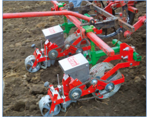
Semoir deux rangs très solide (mais trop coûteux) permettant un écartement constant entre lignes
