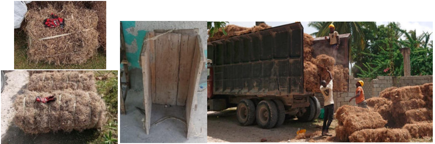
Figure 42 : Illustrations des paquets (gauche), d'un cadre de fabrication de balles (milieu) et d'un chargement de balles (droite) (Crédits photo : MOTSI)
