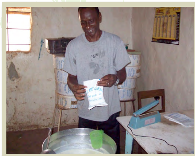
Souleymane DIALLO, gérant de la laiterie "le Berger" dans la salle d'ensachage du lait pasteurisé. Au fond de la pièce, les rouleaux de sachets. Sur la table, la thermosoudeuse pour présenter le lait local dans des emballages améliorés ; une première à Kolda au milieu des années 1990.
