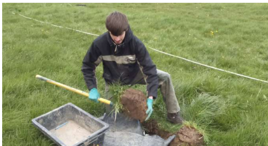
Figure 4.1. Prélèvement d'un bloc de sol à l'aide d'une bêche.
