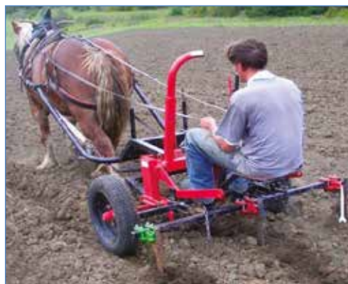
Herramienta TA que permite labrar y luego sembrar con espaciado constante entre filas
