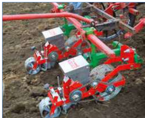
Sembradora de dos hileras muy sólida (pero demasiado costosa) que permite un espacio constante entre filas
